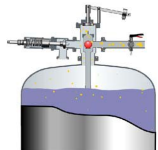
Réinjection de CO 2 (dégazage)
