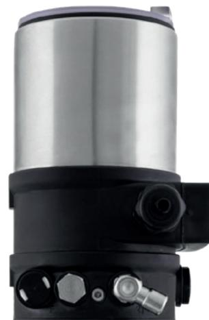
Die digitalen Stellungsregler gehören zur Standardausstattung der KIESELMANN Regelventile mit Hubkolben- und Membranantrieb. Sie zeichnen sich durch eine hohe Regelgenauigkeit aus. Die Stellungsregler arbeiten im Signalbereich von 4 bis 20 mA. Sie regeln aber auch im Teilbereich beziehungsweise Split-Rangebetrieb.
